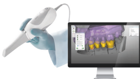
SCANSIONE CON SCANNER INTRA-ORALE E RISULTATO DI UNA SCANSIONE INTRA-ORALE DA SOFTWARE CAD
